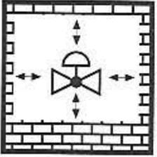
Не допускается прямой контакт между регулятором давления и кирпичными и бетонными стенами, и полом.
